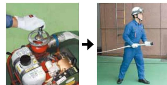
④ 筒先を持った人から合図があったら、放水弁ハンドルを開き放水します。水圧による反動力でバランスを崩さないよう、放水が終わるまでしっかりと保持します。
