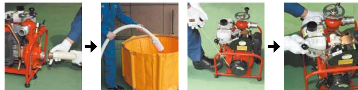
① 吸管を吸水口に結合した後、水源に吸管の先を入れます。
