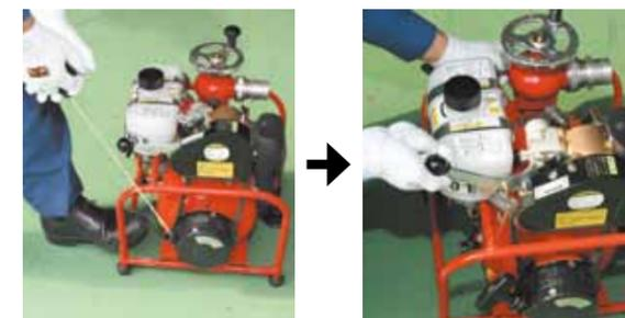
② ポンプのエンジンを始動し、吸水レバーを操作し、吸水します。
