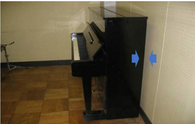
写真3. 壁際の設置例 (壁から10cm程度離す)
