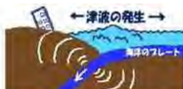
気象庁 web ページ「津波発生の仕組み」 プレートのひずみがはねかえると海面が変動して津波が起こる
