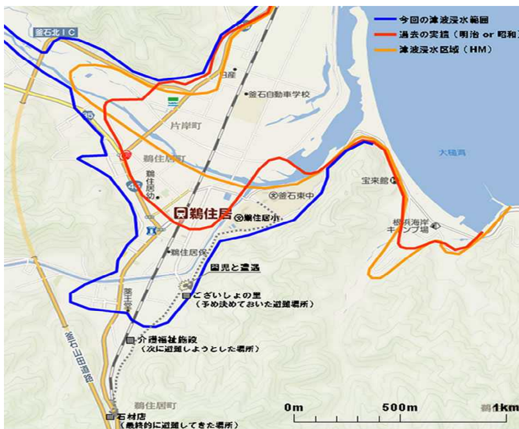
○大槌湾（鵜住居・片岸周辺）の津波浸水範囲
