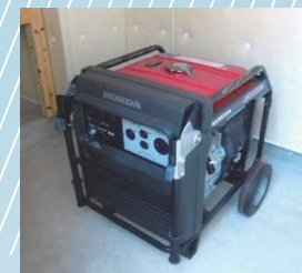
可搬型の非常用発電機
