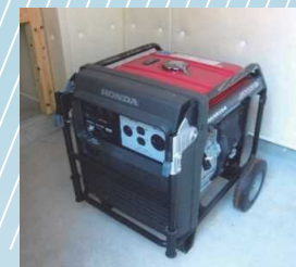
可搬型の非常用発電機
