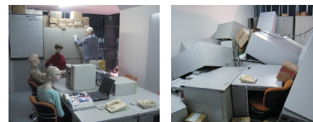
オフィスを復した室内の状況(左:実験前、右:実験後)
