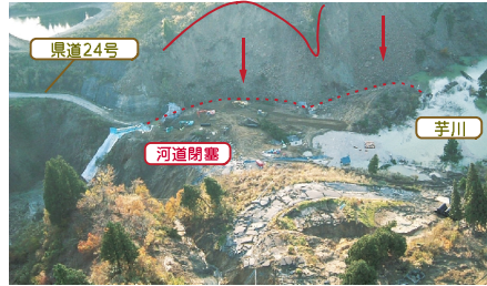
平成16年(2004年)新潟県中越地震 長岡市(旧山古志村)寺野地区 宇川右岸側河道閉塞状況 (国土交通省北陸地方整備局湯沢砂防事務所提供)
