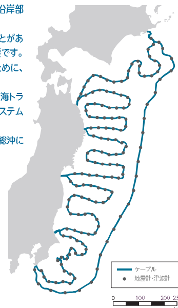
日本海溝海底地震津波観測網(S-net) (独立行政法人防災科学技術研究所提供)
