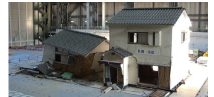
既存木造住宅の移築補強・無補強、破壊実験 http://www.bosai.go.jp/hyogo/research/movie/movie-detail.html#2 動画:独立行政法人 防災科学技術研究所 E-ディフェンス
