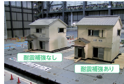
耐震補強の有無による木造家屋の震動破壊実験の様子
