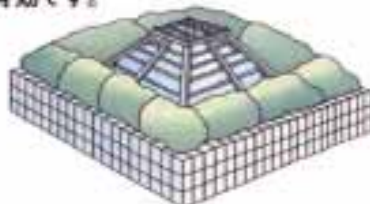
天窗を覆い周辺に植栽を配置した一例
