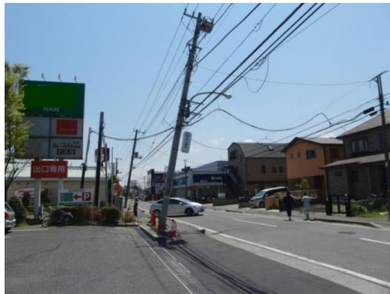
液状化により傾いた電柱（美浜区）
